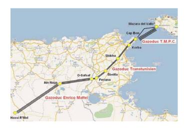
Complessivamente la linea è lunga **2.220 km**, di cui 370 km sono in Tunisia (con diametro di 1.200 mm), 380 km sono sul fondo del mare (con diametro di 650 mm) e 1.470 km in Italia, (con un diametro di 1.200 mm).
